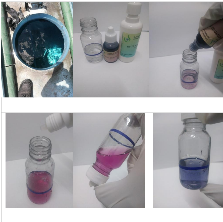
Ilustración 2. Análisis de dureza de agua de pipas.
