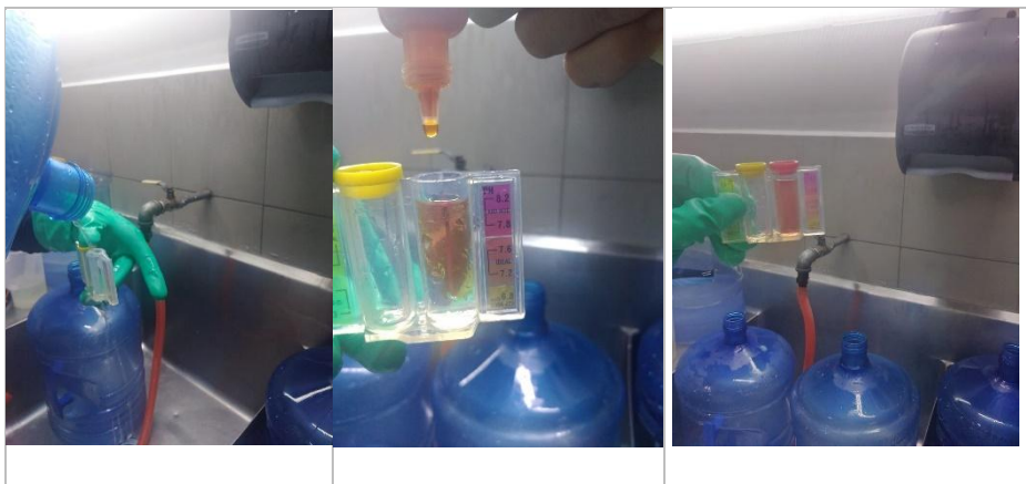
Ilustración 7. Análisis de pH del agua del enjuague de garrafones.
