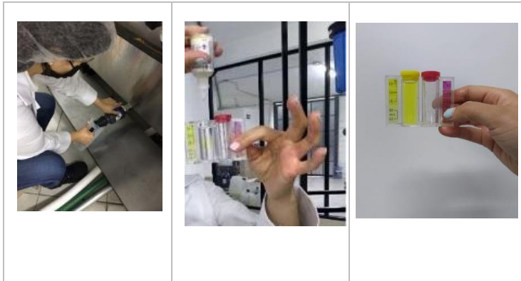
Ilustración 13. Análisis de cloro de agua clorada.
